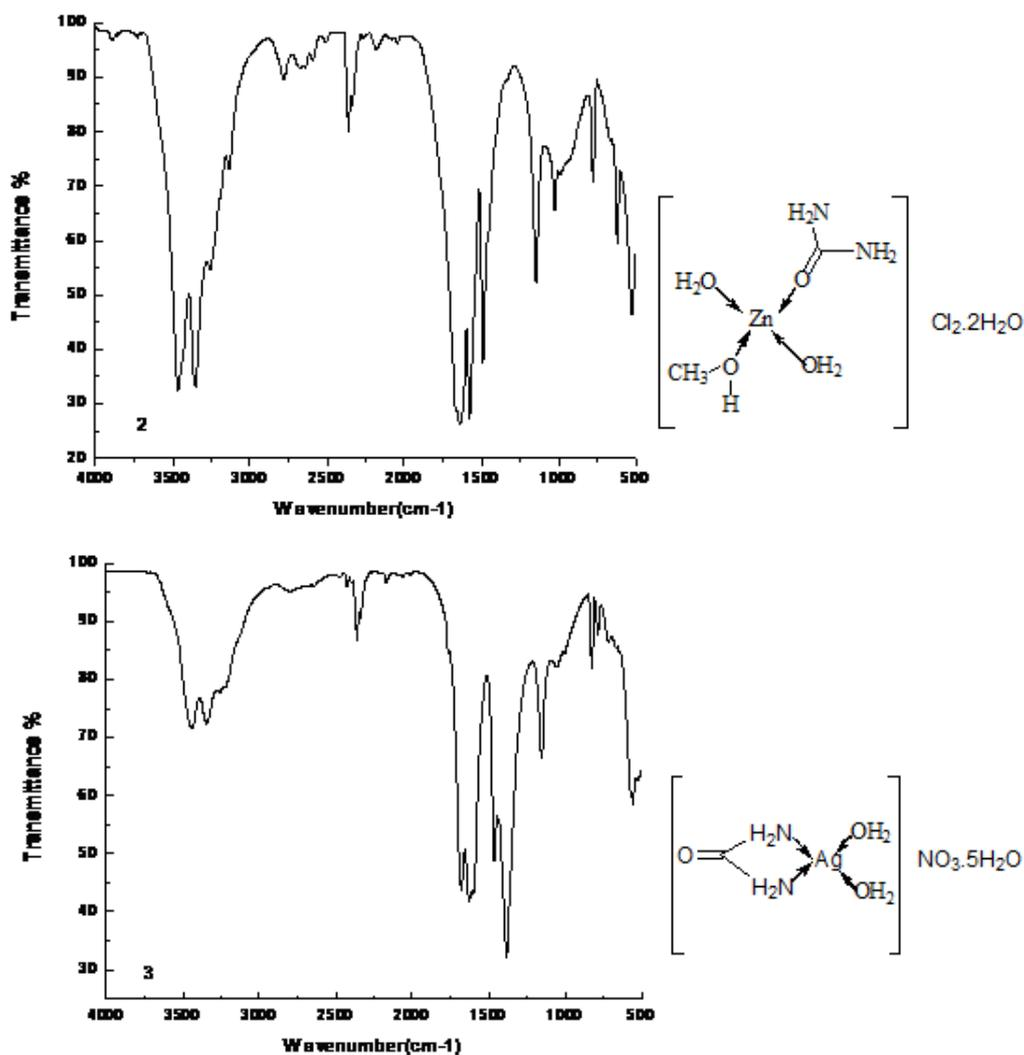
Fig. 1: Infrared spectra of urea complex at room temperature:  $CuCl_2 \cdot U \cdot Me \cdot 4H_2O$  (1),  $ZnCl_2 \cdot U \cdot Me \cdot 4H_2O$  (2),  $AgNO_3 \cdot U \cdot Me \cdot 6H_2O$  (3),  $CdCl_2 \cdot U \cdot Me \cdot 4H_2O$  (4),  $HgCl_2 \cdot U \cdot 4Me \cdot 6H_2O$  (5)
